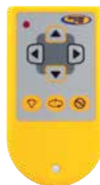
RC601 en option La télécommande vous aide à l'adaptation de l'inclinaison
